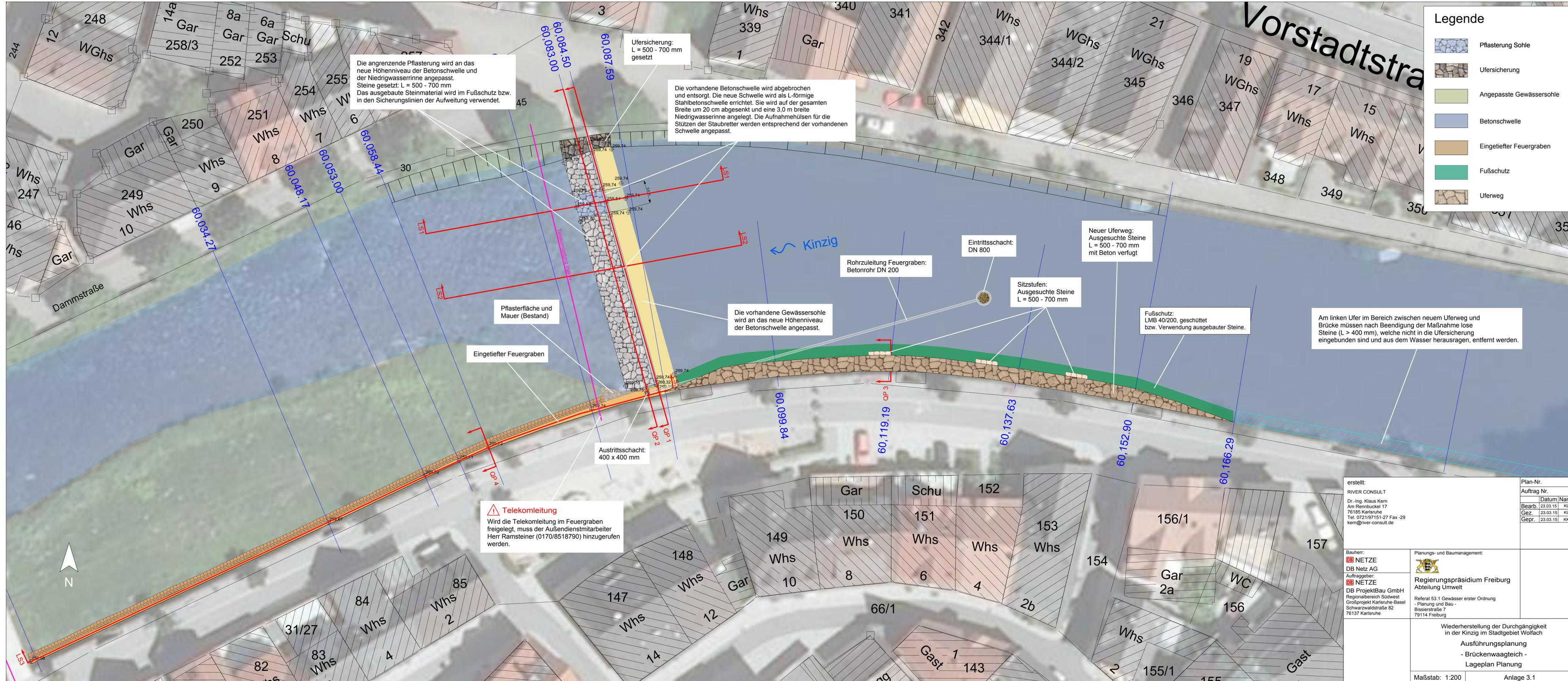
Die angrenzende Pflasterung wird an das neue Höhnenniveau der Betonschwelle und der Niedrigwasserrinne angepasst. Steine gesetzt: L = 500 - 700 mm. Das ausgebaute Steinmaterial wird im Fußschutz bzw. in den Sicherungslinien der Aufweitung verwendet.
