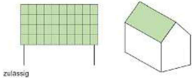
3. Ausführung als in der Dachfläche liegende (parallel zur Dachfläche bzw. der Traufe) Elemente; Vollflächige Anlagen sind Teilflächen vorzuziehen. Mehrere Modulfelder sollten sich aufeinander beziehen bzw. in einer Flucht positioniert werden.
