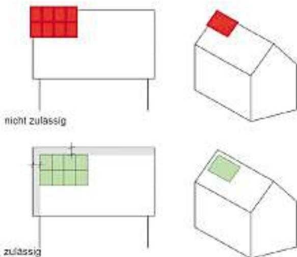
2. Wenn Solaranlagen in die Dachfläche integriert sind (Indach-Photovoltaik oder Indach-Solar), sind sie bis zu 100 % der Dachfläche ohne Abstand zulässig.
