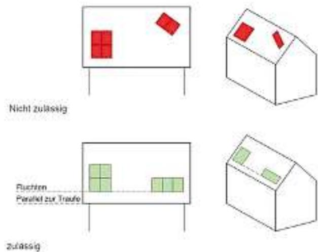
4. Eine Aufständering ist nicht zulässig, die Neigung der Solaranlagenmodule sollen der der Dachneigung entsprechen; Der integrierte Einbau ist vorzuziehen, ist dieser nicht möglich oder unverhältnismäßig, sind Module und Befestigungsmaterialien mit geringer Bauhöhe (kleiner als 20 cm) zu wählen. Ausnahmen für eine Aufständering können in Einzelfällen bei Flachdächern sowie auf Garagen zugelassen werden.
