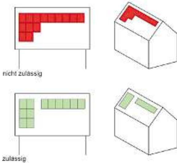
6. Bei Neuinstallationen ist das Mischen von verschiedenen Systemen und Fabrikaten sowie von liegenden und stehenden Modulformen innerhalb einer Anlagengruppe (PV-Module oder Solaranlagen) unzulässig. Im Falle der Erneuerung einzelner Module sind die neu zu gestaltenden Module soweit möglich an die vorhandenen anzupassen.
